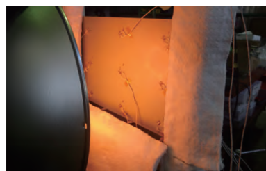
鋼材加温試験
