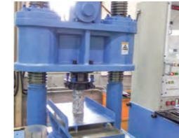
圧縮強度試験
